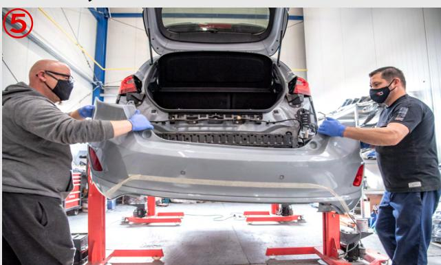
6) Za pomocą dołączonej do zestawu montażowego ściereczki, odtłuśc powierzchnie zderzaka w miejscu obrysu dokładki, które wcześniej zaznaczyłeś taśmą 6a i 6b.
