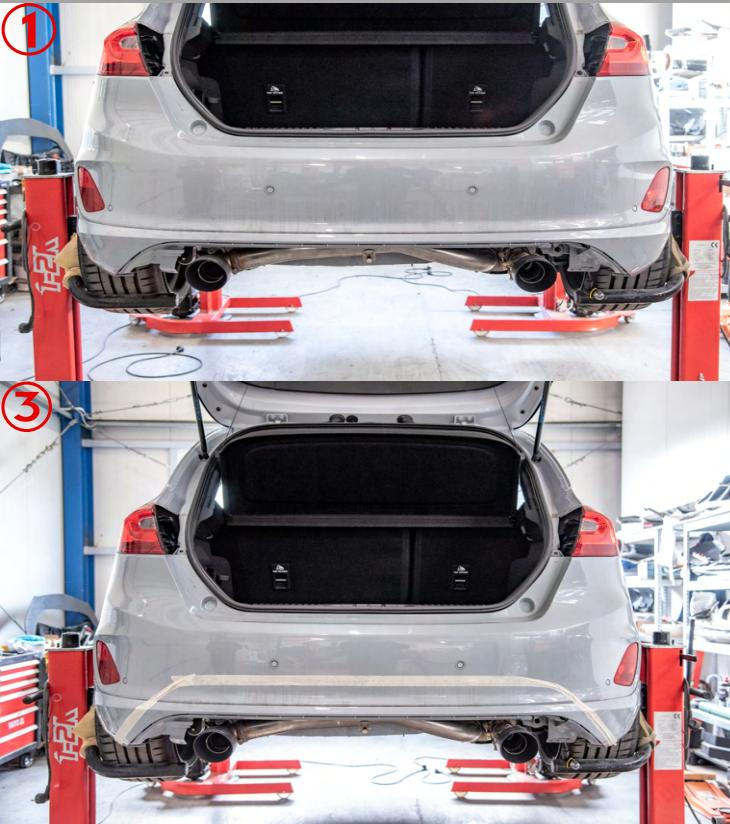
4) Za pomocą markera zaznacz punkty na taśmie oraz dokładce, w dalszym etapie zapewnia poprawne umiejscowienie dokładki 4.
