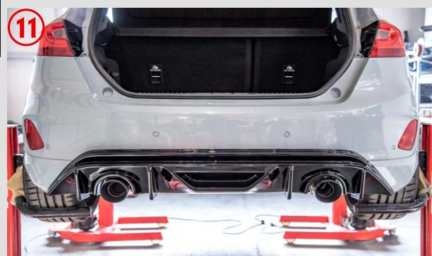
12) Dokręć dokładkę do podwozia samochodu używając oryginalnych otworów montażowych oraz oryginalnych śrub 12a i 12b.
